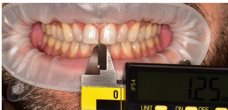
Фигура 12. Интраорално измерване на ширината на максиларна диастема, посредством дигитален шублер Microtech BIG SCREEN.
