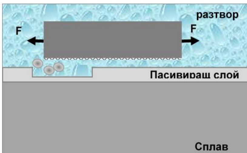
Фиг. 1-20 Схема на трибокорозия адаптирана от [A. Lopez-Ortega, J.L. Arana, R. Bayon; Wear 456-457 (2020) 203388]
