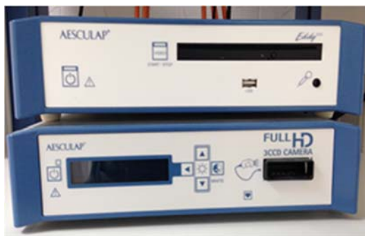
Сн. 10. Записващо устройство за видеодигитализация и архивиране
