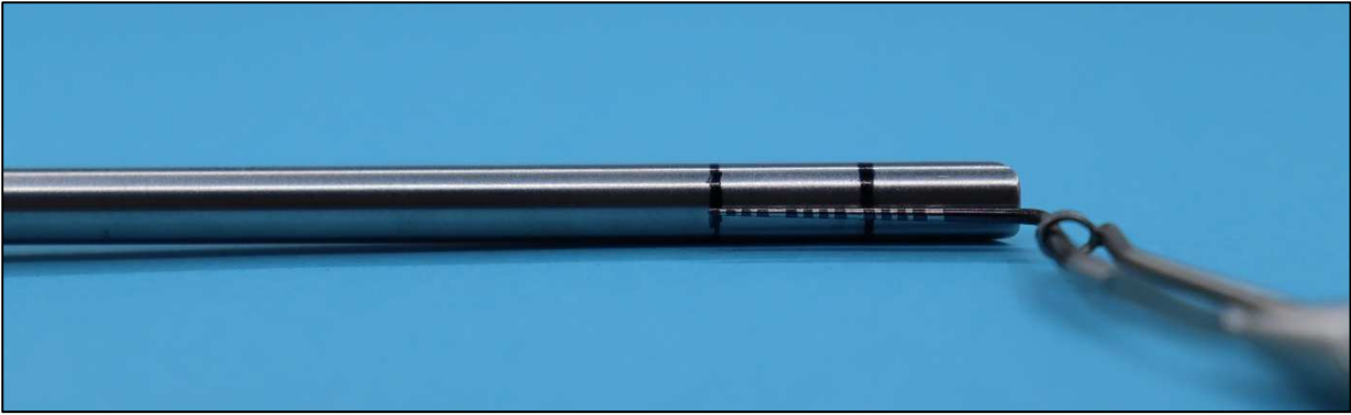
Фигура 34. Отбелязване на отправна позиция от 20 мм върху канюлата.
