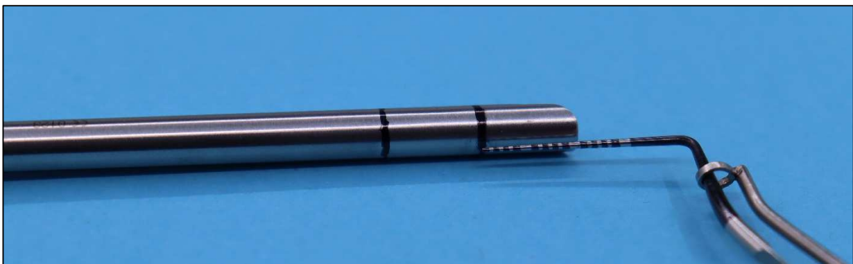
Фигура 33. Отбелязване на отправна позиция от 10 мм върху канюлата.
