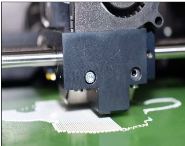
Фигура 24. Движение на екструдерната глава, нанасяща разтопен филамент по повърхността на масичката
