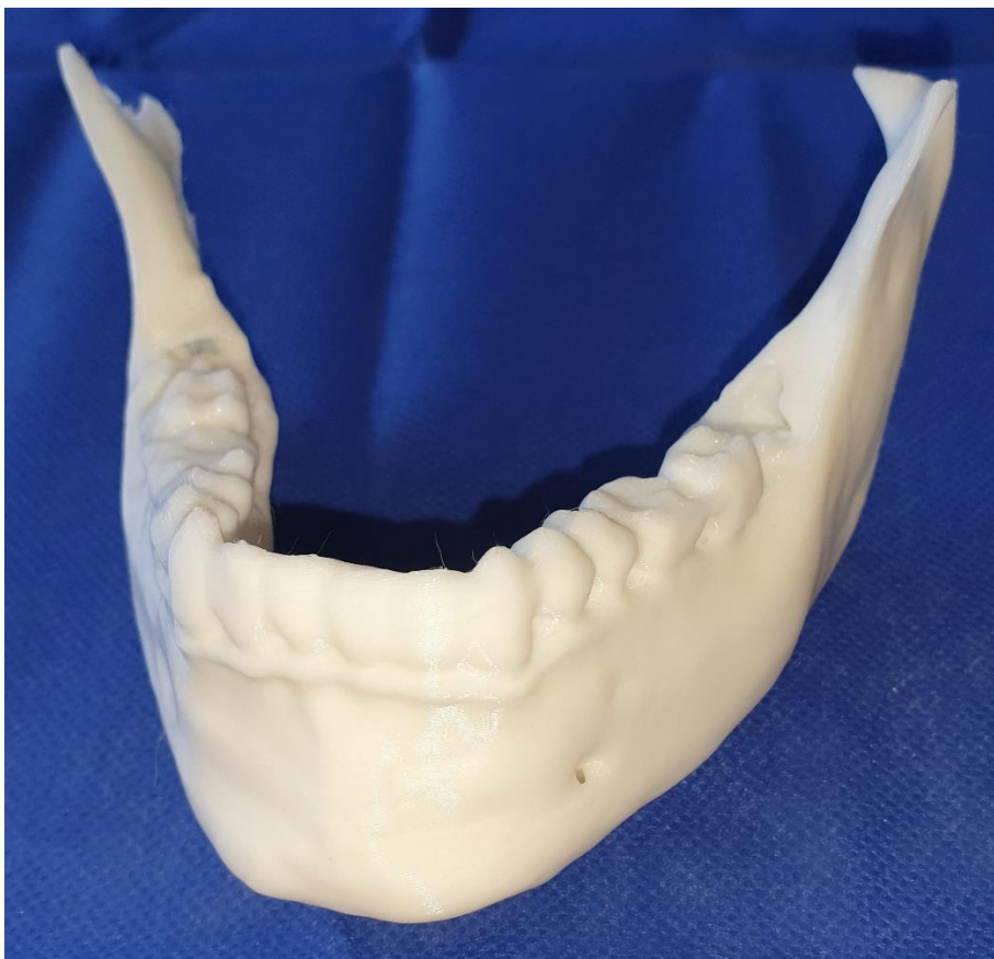
Фигура 18. Принтиран модел по технология FDM, след почистване и премахване на опорите. Наблюдава се характерната гланцирана повърхност на готовият модел, както и отделните слоеве.
