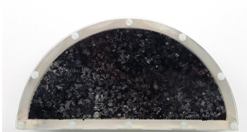
Фигура 5.1. Снимка на физичен фантом на гърда пълен с вода
