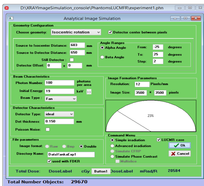
Фигура 4.4. Изглед от XRAYImagingSimulator за генериране на планарни изображения в мамографията и томосинтезата
